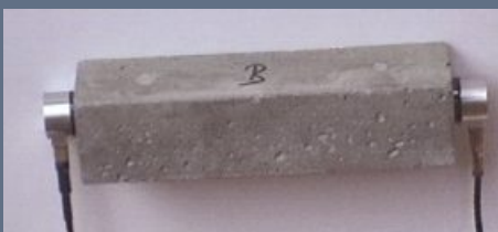
Prüfung einer Mörtelprobe in Durchschallung zur E-Modul-Bestimmung
