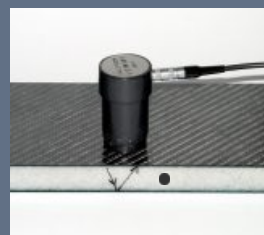
Impuls-Echo-Prüfung einer CFK-Sandwich-Probe mit Schaumkern
