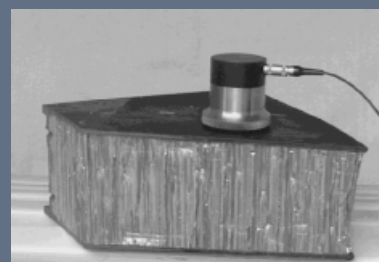
Impuls-Echo-Prüfung einer CFK-Sandwich-Probe mit Aluminium-Waben
