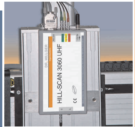
Am Scanner montierte Sender- und Empfangseinheit
